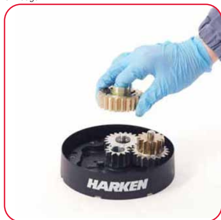
13. Retirer l'engrenage et enlever les cliquets. Pour faciliter l'opération, presser le ressort contre le cliquet à l'aide d'une lame.
