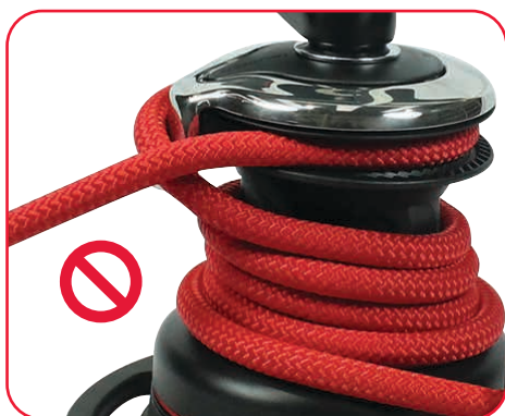
Tours excessifs à la base du treuil
