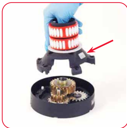
11. Retirer le support du tambour. Noter le numéro de série du treuil et l'enregistrer.
