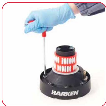
10. Dévisser les 6 vis hexagonales en acier inoxydable (8 Nm/71 in-lb) NOTE pas celles peintes en rouge
