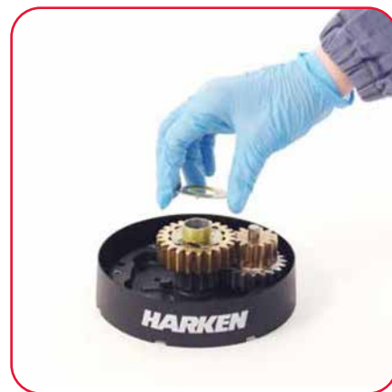
12. Retirer la rondelle. Important : la rondelle peut rester à l'intérieur du support du tambour !
