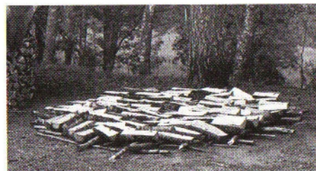
Faites un "sol perdu" de bois fendu sur les perches. Tournez le côté des écorces vers le bas.
